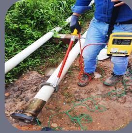
EN EL ÁREA MECÁNICA SE REALIZÓ INSPECCIÓN VISUAL DE LA SOLDADURA E INSPECCIÓN DEL RECUBRIMIENTO DE LA TUBERÍA POR ESPESORES Y CONTINUIDAD.
